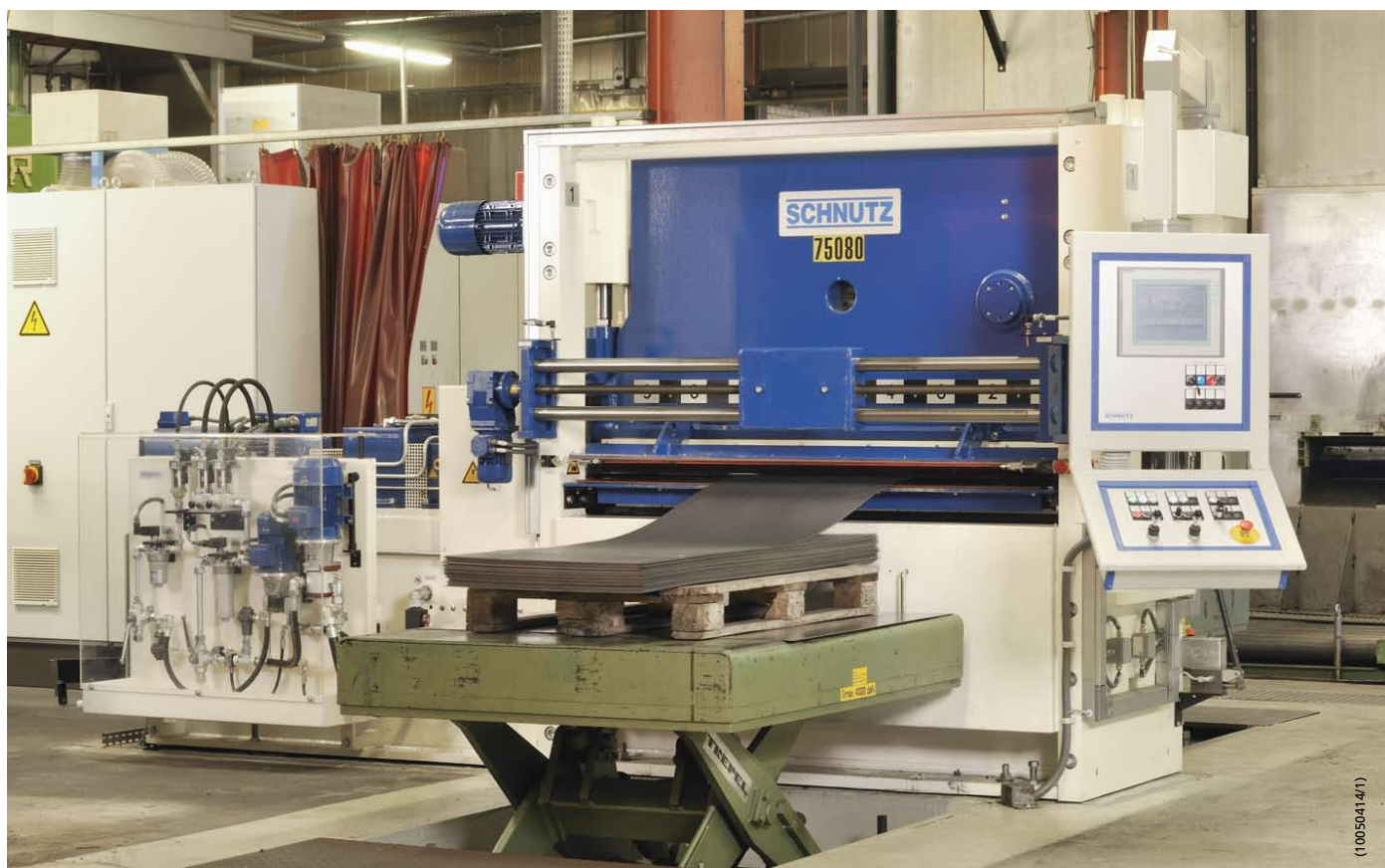
Hochleistungslochblechrichtmaschine von SCHNUTZ im Einsatz bei der Friedrich Graepel AG in Löningen. Die Maschine ist mit einer Wechselladung mit 23 Richtwalzen ausgerüstet (Fotos: SCHNUTZ).
