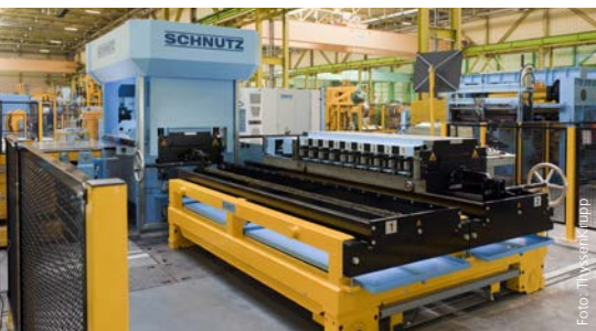
Hochleistungsrichtmaschine mit Wechselkassetten
