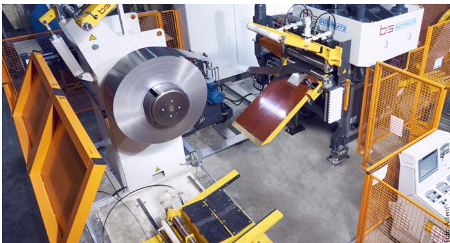
Bandzuführanlage für hochfesten Stahl in einer Fertigungsanlage für Sitzschienen
